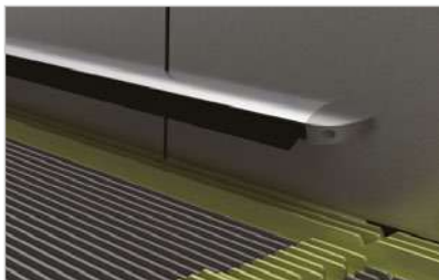
Защита от захвата Чтобы пассажиры не стояли слишком близко к краю ступеней, избегайте ситуации, при которой ступени втягивают ногу в зазор между лестницей и нижней панелью.
