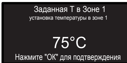
Изменение температуры горячей воды отопления
